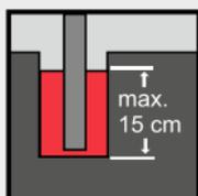
**OTTERFIX<sup>®</sup>** Schnellbeton einfach und ohne aufwändiges Anmischen zu verarbeiten. Schüttungen in Lagen von bis zu 15 cm in das vorbereitete Loch einstreuen und nach Ausrichtung des Einbauteils mit der erforderlichen Wassermenge angeben.
